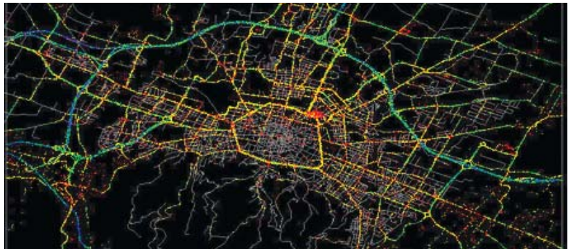
Mappatura elettronica delle principali strade di Bologna. Le traiettorie delle auto sono monitorate attraverso un sistema GPS attivo sul 3% di tutti i veicoli circolanti
